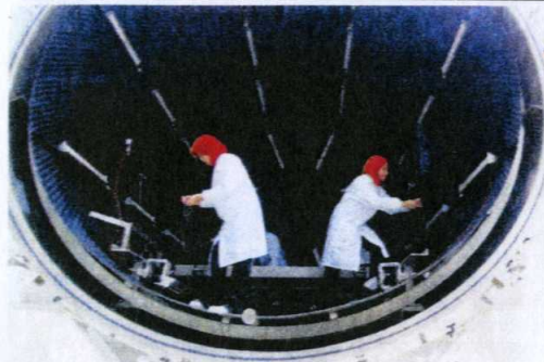
PETUGAS AIT Pusat Angkasa Negara membuat persiapan sebelum kerja-kerja pengujian satelit pada Kebuk Vakum Termal.
